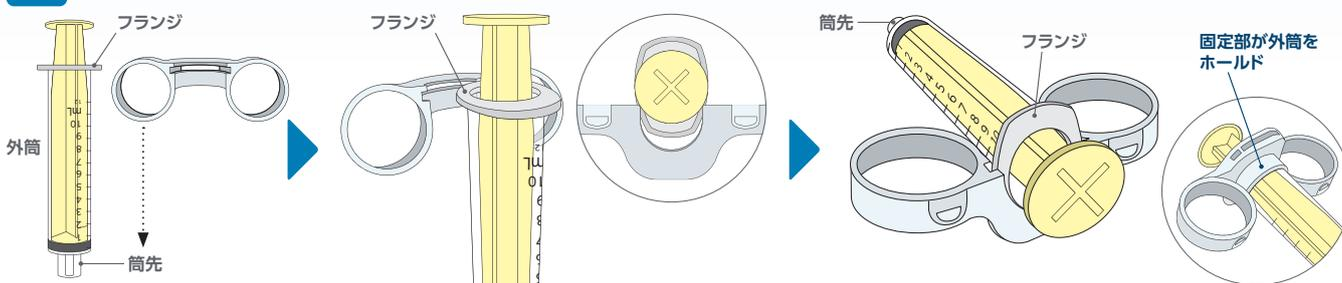
フィンガーリングがフランジの筒先側に来るように接続する
