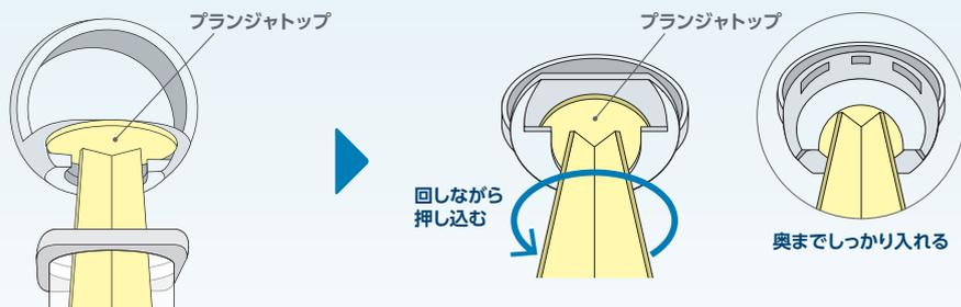
プランジャアシスタの接続部にプランジャトップを挿入する
